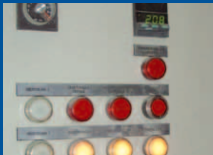
Pulverit paistuvat kiiltäväksi ja kestäväksi pinnoitteeksi noin 200 asteen lämpötilassa.
