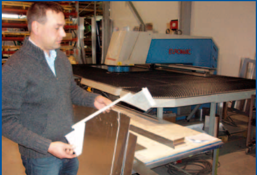
Mika Vehmas esittelee ohutlevyn muotoilua. Taustalla oleva kone leikkaa valorakenteiden ohutlevyjen alumiiniosat oikeaan muotoon ja lävistää reiät valmiiksi.
